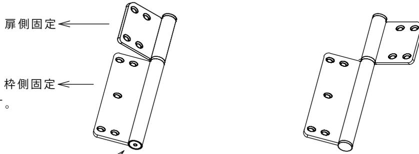
開閉速度調整 (六角ネジ 5.5mm)
